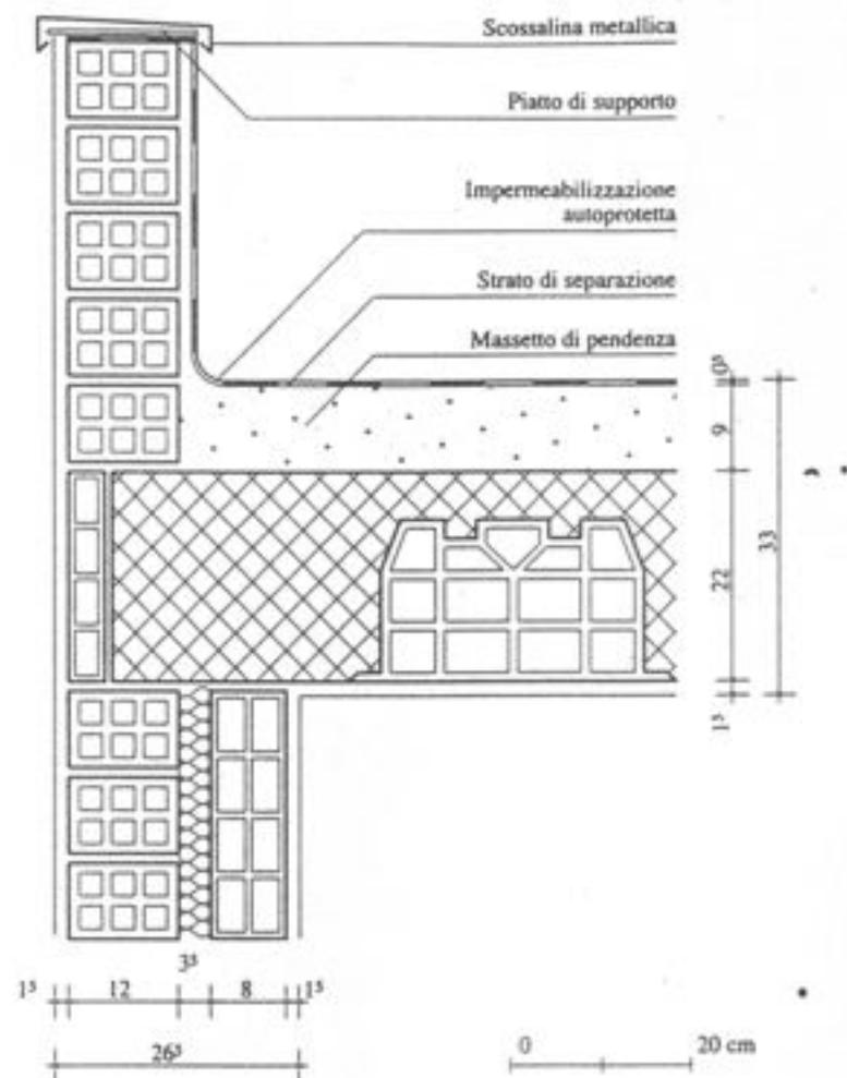
**Copertura continua** non praticabile con manto bituminoso autoprotetto (BPP) su massetto di pendenza in cls alleggerito
