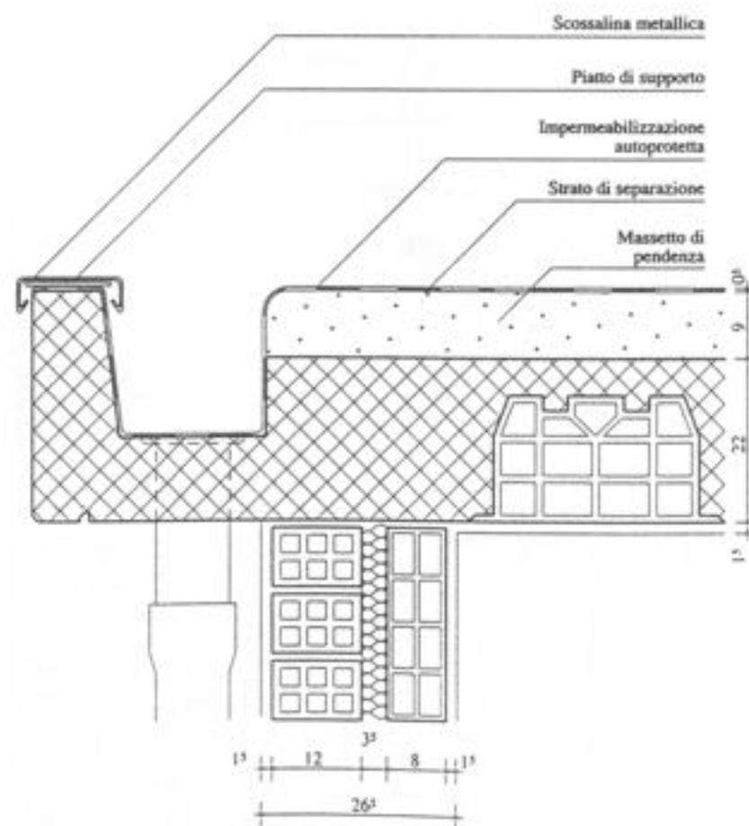
**Copertura continua** non praticabile con manto bituminoso (BPP) autoprotetto su massetto di pendenza in cls alleggerito
