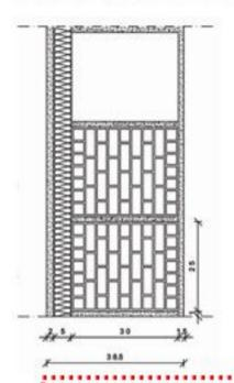
La collocazione dello strato termoisolante verso l'esterno della parete ne OTTIMIZZA L'INERZIA TERMICA sfruttando la capacità di accumulo della massa dell'elemento di supporto
