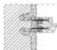
2) FERRAGGIO DEL TELAI FISSO AL CONTROTELAIO
