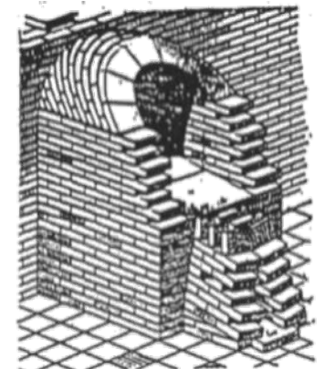
Passaggio coperto a volta di mattoni in Mesopotamia
