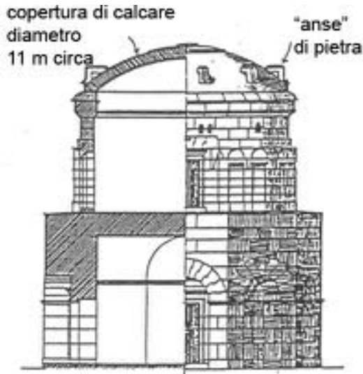
Mausoleo di Teodorico, Ravenna (530) – sezione dell' opera monolitica di calcare istriano.
