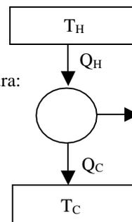
Il rendimento della macchina che opera secondo un ciclo di Carnot (macchina ideale) può essere calcolato in funzione delle temperature delle due sorgenti:
