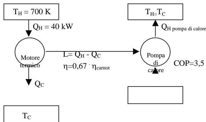
Se il rendimento del motore è pari a 0,25, e se questo è pari al 67% di quello di un ciclo di Carnot che opera alle stesse temperature, è possibile ricavare il valore del rendimento di Carnot che vale:
