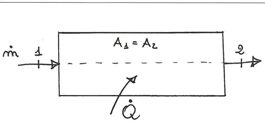
Fig.3.5 – Schema di sistema aperto
