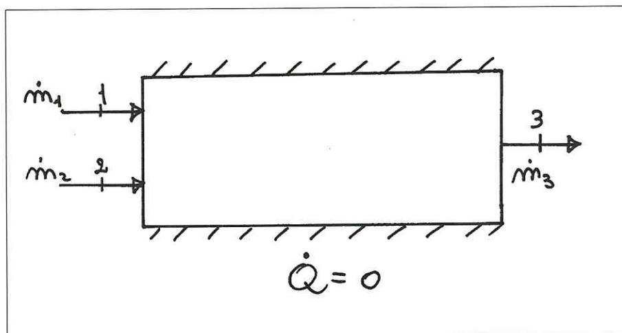
Fig. 3.6 - Schema di sistema aperto: condotto orizzontale con due ingressi ed un'uscita con pareti adiabatiche
