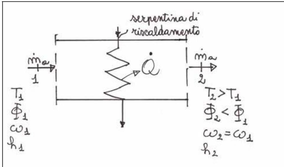
Fig.2.3.1.2 – Schema di componente per il semplice riscaldamento
