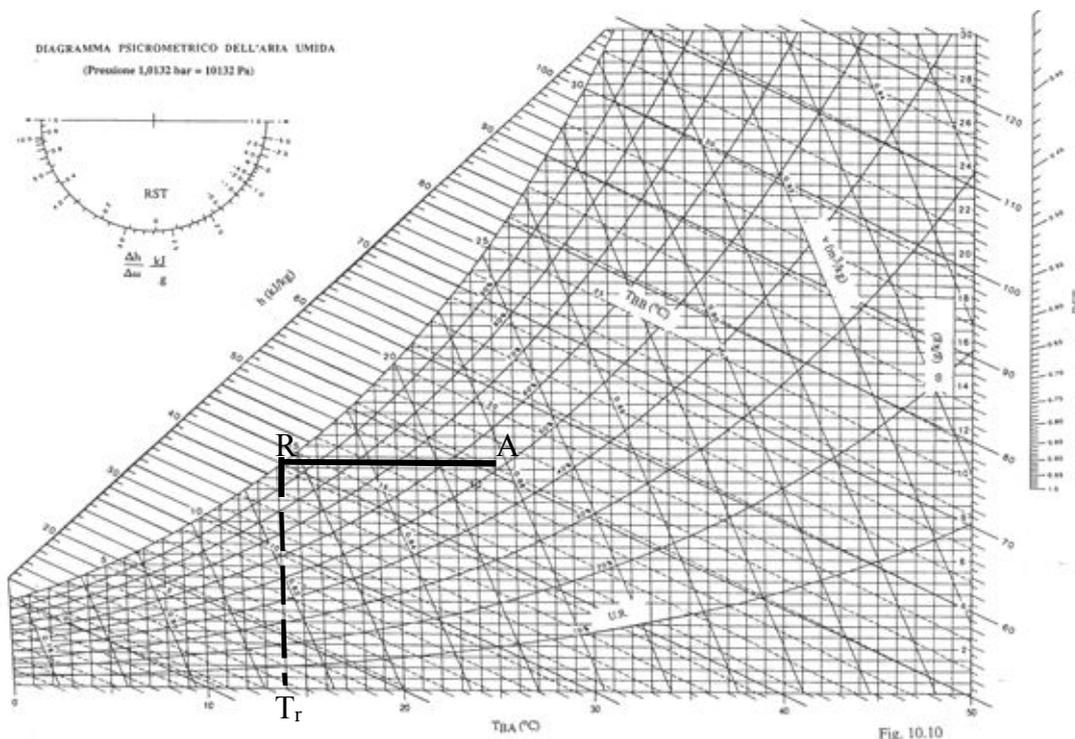
Fig.2.2.3 – Determinazione grafica della temperatura di rugiada
