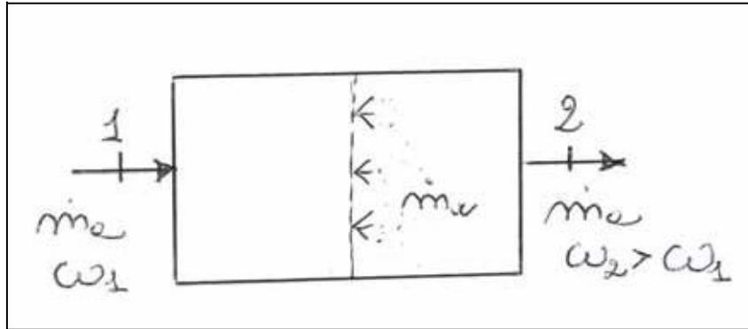
Fig.2.3.4.1 – Schema di componente per l'umidificazione adiabatica
