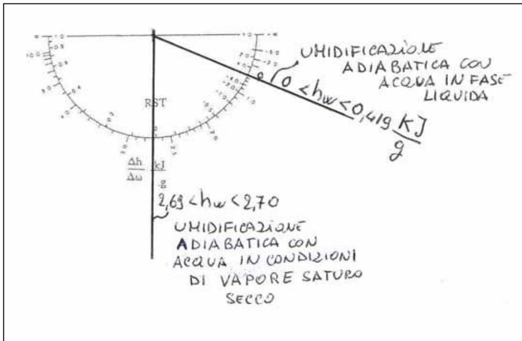
Fig.2.3.4.2 – Pendenza delle trasformazioni di umidificazione adiabatica
