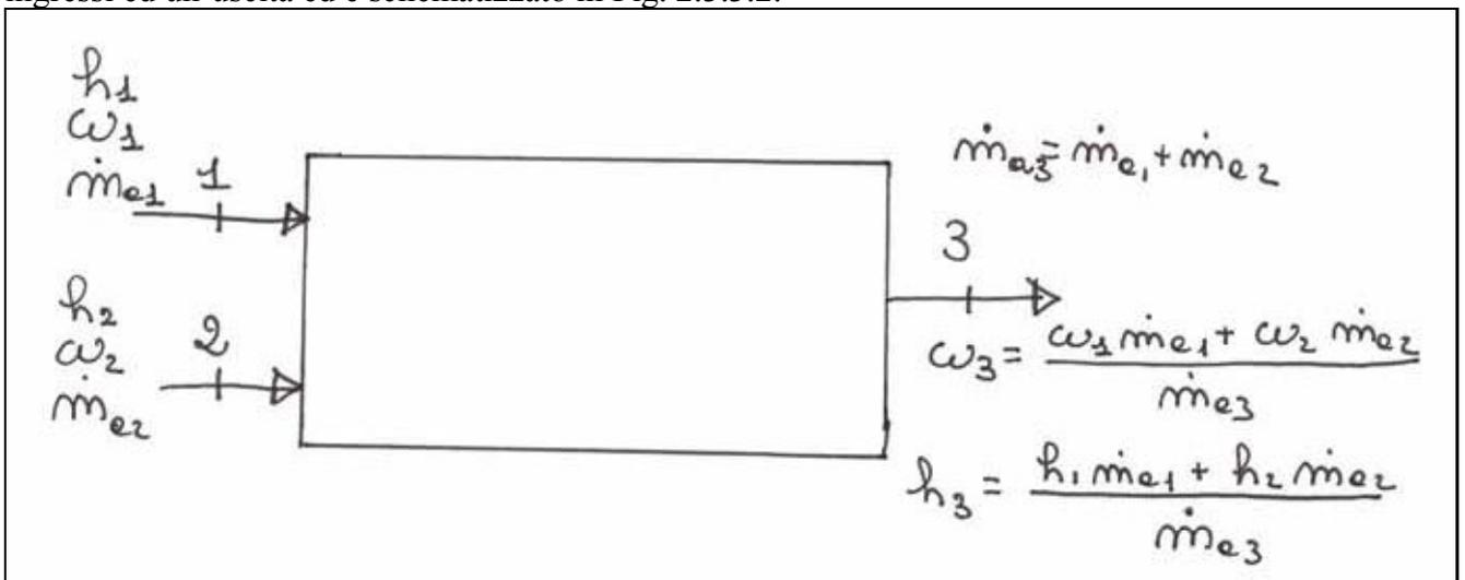
Fig.2.3.3.2 – Schema di componente per il mescolamento adiabatico
