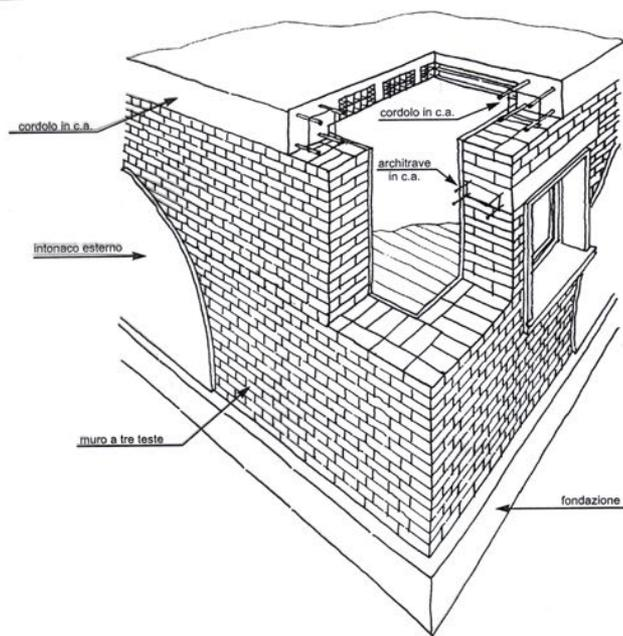
Assonometria con pilastri in c.a.
