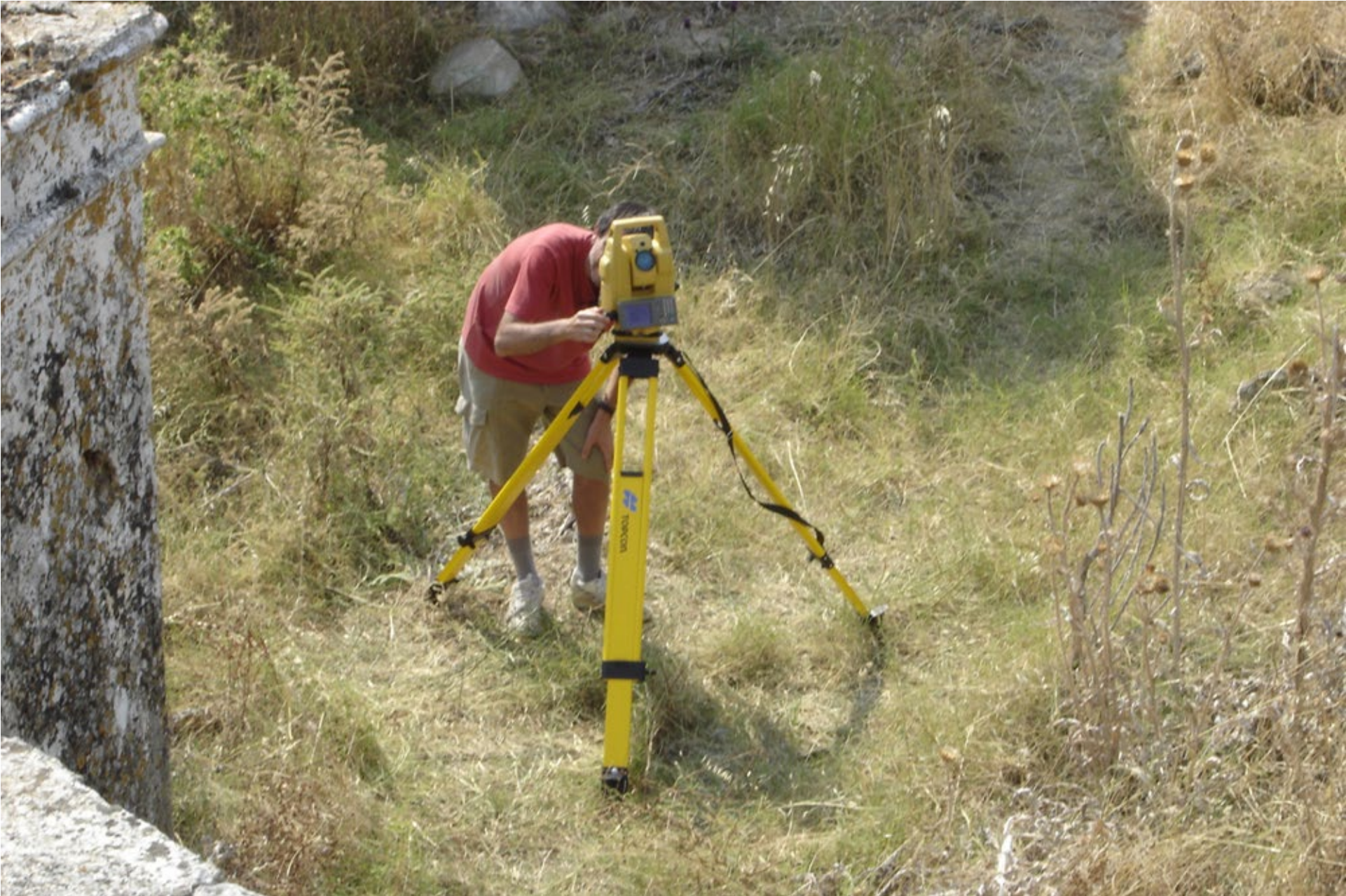
Rilievo tramite stazione totale della masseria Solano a Montegiordano (CS).
