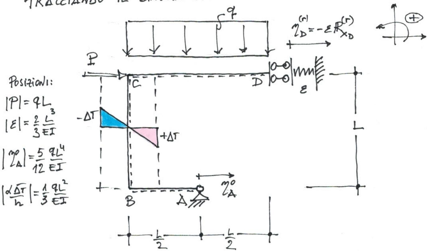
POSSIBILI SCELTE DEL SISTEMA PRINCIPALE ISOSTATICO:
