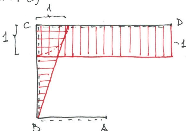
L'unico equazione di Müller-Breslau, corrispondente all'unica incognita iperstatica  $x_1$ , si scrive nella forma  $L_{re} = L_{ri}$  assumendo come sistema lavorante o fittizio lo schema [1] e come sistema reale le strutture iperstatiche date. Si ha:
