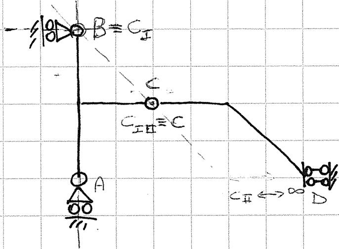
Essendo soddisfatto sia lo CN che lo CS di isostaticità il sistema analizzato è isostatico!
