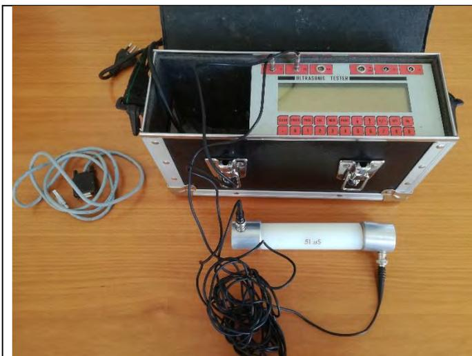
Strumentazione ad ultrasuoni per indagini sul calcestruzzo.
