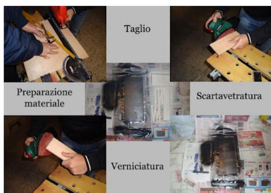
Successivamente ho scelto un pannello di legno multistrato, poi tagliato in otto pezzi proporzionati all'altezza max stabilita di 40cm, e verniciati, con vernice spray, nei colori nero, bianco e grigio. Una volta attesi i tempi di asciugatura, ho iniziato a montare il modello con colla bicomponente, ed ecco il risultato.
