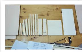
**STRUTTURA:** da una tavola di legno di 1x5mt ho ricavato 13 listelli di 1,40x 1,4 (lunghezza variabile) e 2 tavolette di 1,40 di spessore per realizzare i braccioli; una volta tagliato il legno tramite la carta vetrata ho limato ciascun listello; successivamente mi sono occupata dell'assemblaggio strutturale utilizzando trapano e viti autofilettanti; montato ogni singolo listello, ho verniciato con i colori originali dell'opera (nero e giallo cromo).
