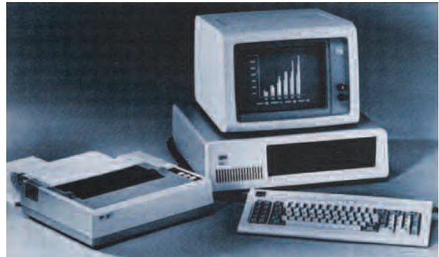
55 - Il primo personal computer IBM XT con processore 8088 a 4,77 MHz. Disponeva di 16 KByte di Ram.
