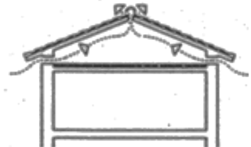
Copertura isolata ventilata
