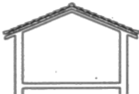
Copertura isolata - non ventilata
