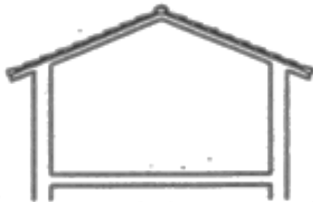
Copertura non isolata - non ventilata
