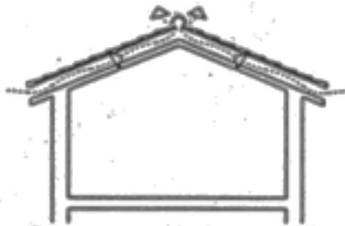
Copertura non isolata - ventilata
