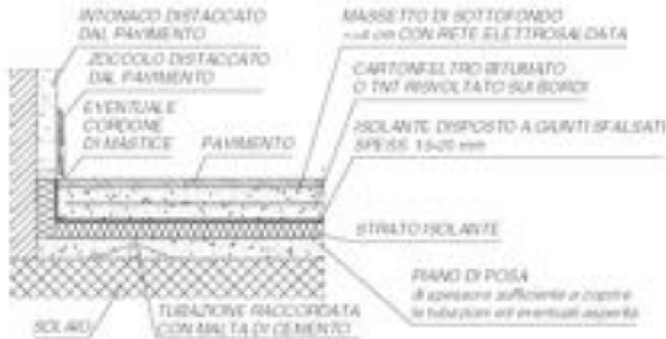
FIG. F.2.3.5 PAVIMENTO GALLEGGIANTE DETTAGLI COSTRUTTIVI
