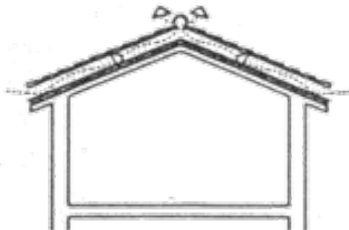
Copertura isolata ventilata
