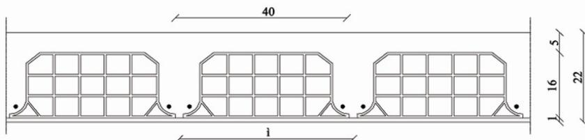
I travetti sono gettati in opera. La sagoma delle pignatte fornisce una cassaforma per il getto. L'intonaco all'intradosso del solaio ha un supporto continuo ed omogeneo
