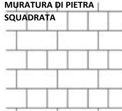
Composta con pietre di geometria pressoché parallelepipeda poste in opera a strati regolari. Lo spessore minimo deve essere 24 cm.
