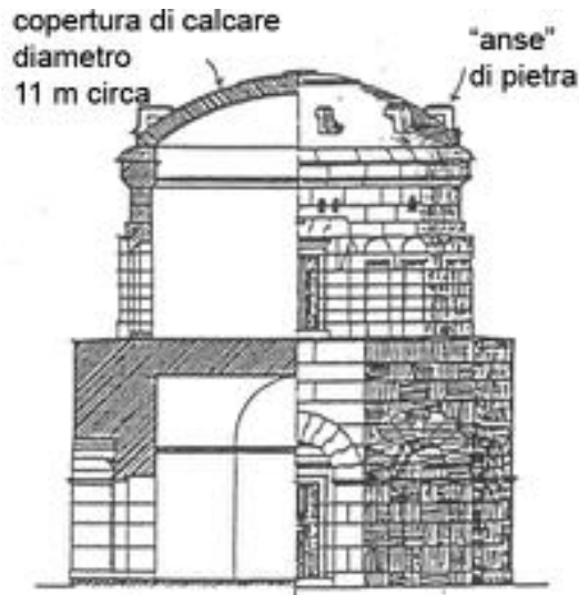
Mauseleo di Teodorico, Ravenna (530) – sezione dell' opera monolitica di calcare istriano.
