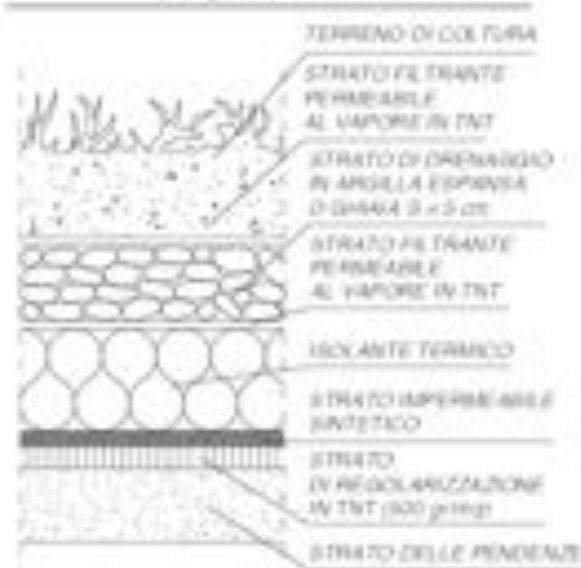
FIG. F.2.5/16 TETTO GIARDINO REALIZZATO CON IL SISTEMA DEL TETTO ROVESCO
