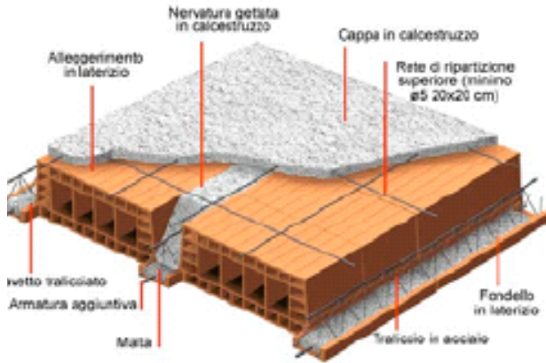
SOLAIO A TRAVETTI TRALICCIATI "BINATI"
