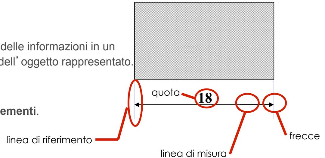
Una quota viene rappresentata da una linea di misura confinata tra due linee di riferimento. Le estremità della linea di misura sono evidenziate con frecce o tratti obliqui. Il valore numerico della quota (solitamente in **cm** per le dimensioni lineari, in **gradi** per quelle angolari) è sempre riferito alle dimensioni reali (indipendentemente dalla scala).
