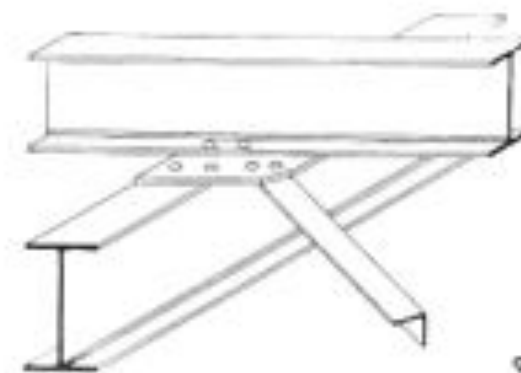
9 Se i travetti appoggiano sulle sotto-travi, staticamente conviene porre il controventamento nel piano dell'ala inferiore del travetto di solaio.
