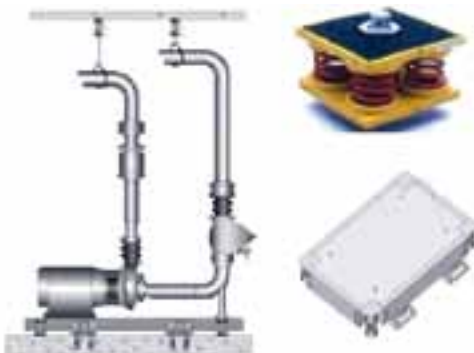
Figura 17 - Esempio di fissaggi ammortizzati delle macchine e dei condotti alle strutture edilizie
