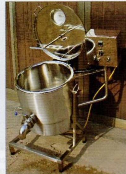
Fig. 8.25 – Soluzione minimale per minicaseificio ad alimentazione elettrica: a sinistra una caldaietta da 70 litri.
