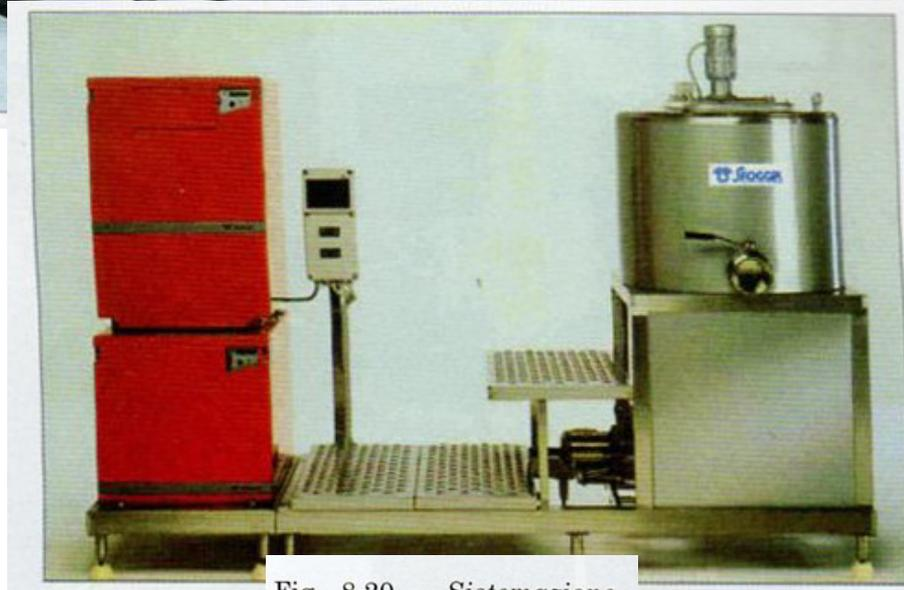
Fig. 8.20 – Sistemazione accoppiata caldaia - gruppo su pedana.
