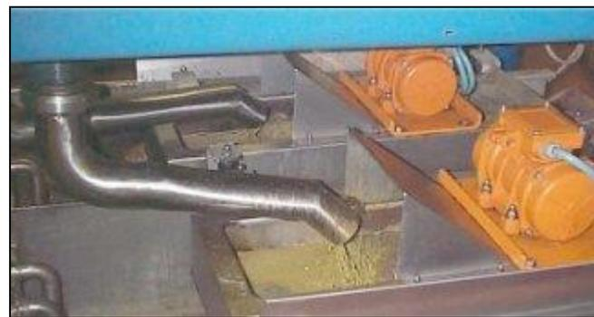
Due delle tre uscite - decanter Alfa-Laval
