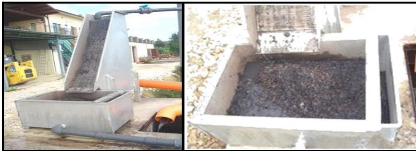
Figura 17 Sgrondo statico autopulente
