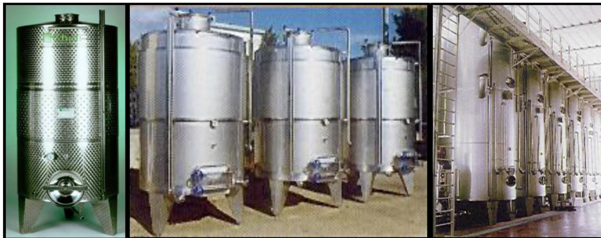
Figura 38 Vinificatori in acciaio inossidabile AISI 304 e AISI 316
