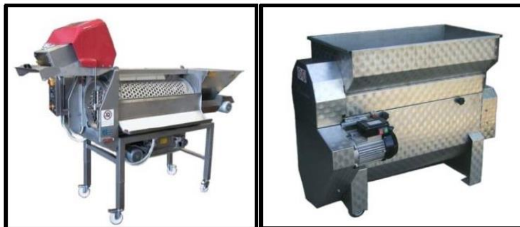
Figure 5 Pigiadiraspatrici costruite in acciaio inox AISI 304.
